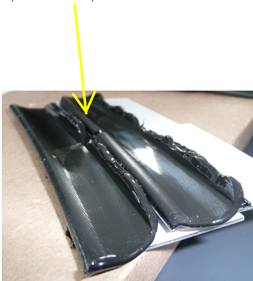
Imagem 2: Impressão da superfície do flanco do dente do eixo rápido
